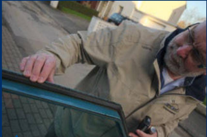
**Auch die Türdichtungen prüft der Sachverständige auf Beschädigungen, die im schlimmsten Fall einen Wassereinbruch nach sich ziehen können.**
