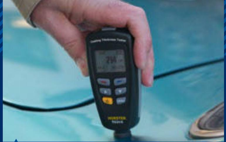
Die erhöhte Schichtdicke an dieser Stelle ist noch kein Grund zur Sorge, der Lack auf waagerechten Flächen fällt oft dicker aus.
