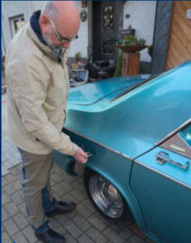
Mit dem Lackschichtdickenmessgerät lässt sich feststellen, ob sich Spachtelstellen unter dem Lack verbergen.
