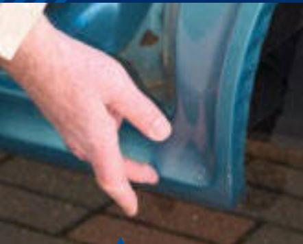
**Am Übergang vom Einstieg zum Radlauf meldet das Messgerät eine Spachtelschicht, die Blase im Lack kündigt Handlungsbedarf an.**
